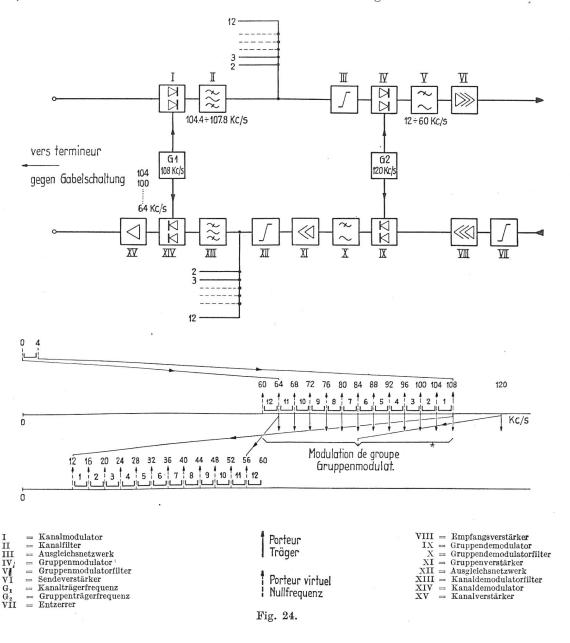
Der Anruf auf den Kanälen bewerkstelligt sich in der gleichen Weise wie bei den gewöhnlichen Vierdraht-Verbindungen. Da diese Stromkreise in die Bündel der automatischen Leitungen, der Tandemoder der Terminalleitungen, eingeführt werden sollen, hat man ein Impulsübermittlungssystem mittels eines Stromes von einer Frequenz von 3000 Hz vorgesehen. Diese Vorrichtung ist direkt mit der Gabelschaltung verbunden und bildet nicht Bestandteil des eigentlichen Trägerstromsystems.
