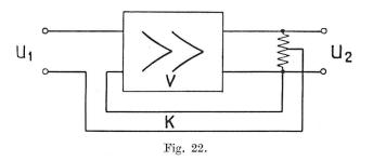
Bedeutet v die Verstärkung und k den Teil der Ausgangsspannung, die zum Eingang zurückgeführt wird (wobei k auch als die Dämpfung eines zwischen Verstärkerausgang und -eingang eingeschalteten Dämpfungsgliedes betrachtet werden kann), so erhält man ohne Gegenkopplung
