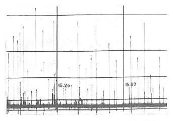
Fig. 2. Geräuschspannungs-Aufnahme einer Lokalverbindung in Thun
