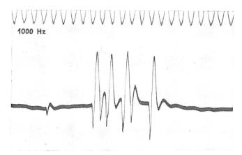
Fig. 1. Wählerkratzer infolge defekter Litze
