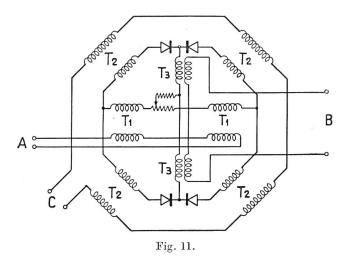
Es können Modulatoren mit Trockengleichrichtern gebaut werden, die in befriedigender Weise mit Frequenzen bis zu 100 kHz arbeiten. Für höhere Frequenzen muss die Kapazität der Elemente in Betracht gezogen werden.
