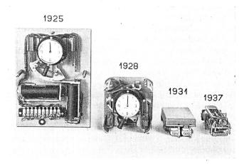
Fig. 10. Zeitschalter der Firma Hasler AG. Bern Zeitschalter aus den Jahren 1925 und 1928, unter Verwendung des normalen Telephonometers Zeitschalter aus dem Jahre 1931 Neuestes Modell aus dem Jahre 1937
