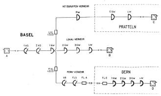
Fig. 3. Verbindungsdiagramm für Orts-, Netzgruppen- und Fernverkehr (Basel)
