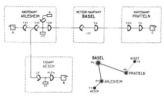
Fig. 5. Verbindungsdiagramm für Netzgruppenverkehr (Arlesheim-Pratteln)
