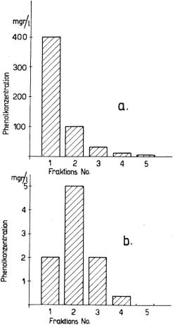
Fig. 4. Phenolkonzentration in verschiedenen Fraktionen des Wasserdampfdestillates
