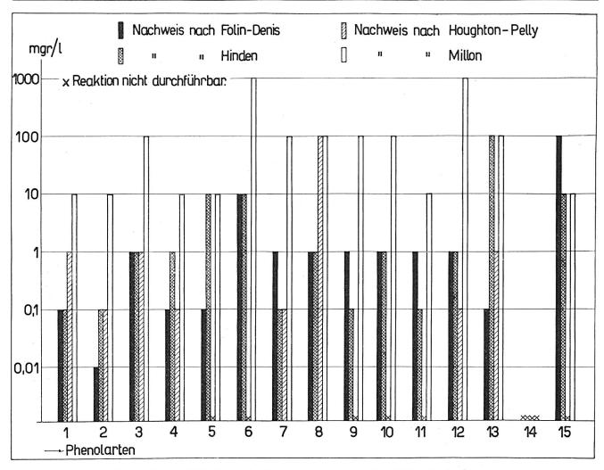
Fig. 2. Empfindlichkeit von vier Phenolreagenzien gegenüber 15 Phenolverbindungen
