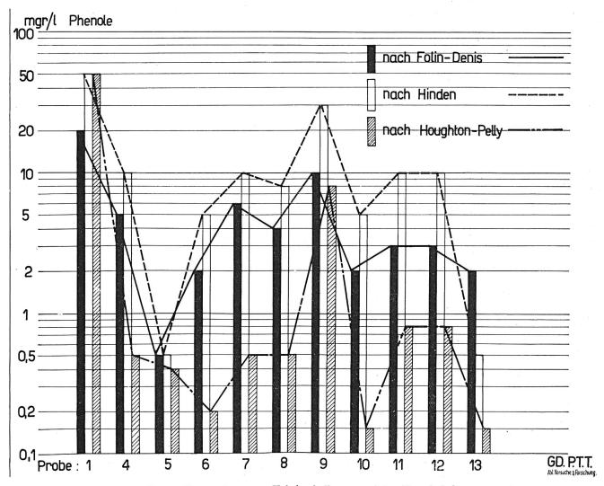
Fig. 3. Untersuchung von Kabelumhüllungen auf den Phenolgehalt
