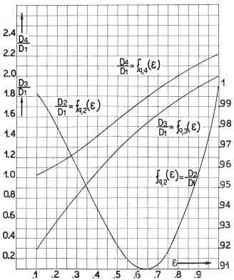
Fig. 1. Distorsioni composite «specifiche» armoniche (D<sub>2</sub>/D<sub>1</sub>), non armoniche (D<sub>3</sub>/D<sub>1</sub>) e globali (D<sub>4</sub>/D<sub>1</sub>) per un canale telefonico a caratteristica di lavoro quadratica, eccitato con uno spettro binario (due onde aventi rapporto d'ampiezza  $\varepsilon$ )
