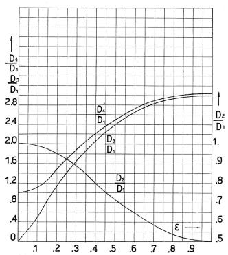
Fig. 4. Distorsioni composite specifiche armoniche (D<sub>2</sub>/D<sub>1</sub>), non armoniche (D<sub>3</sub>/D<sub>1</sub>) e globali (D<sub>4</sub>/D<sub>1</sub>) di un circuito telefonico a caratteristica di lavoro cubica-simmetrica nel caso in cui le ampiezze delle due onde dello spettro eccitatore siano vincolate alla condizione di invarianza della potenza elettrica di uscita rispetto al caso di eccitazione semplicemente sinoidale
