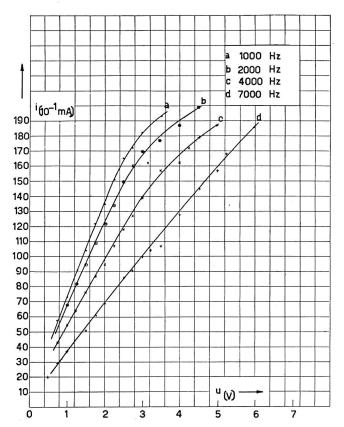
Fig. 6. Caratteristiche di lavoro della corrente uscente in funzione della tensione applicata u del circuito virtuale musicale di cui in fig. 5 assumendo come parametro di ogni diagramma la frequenza impressa
