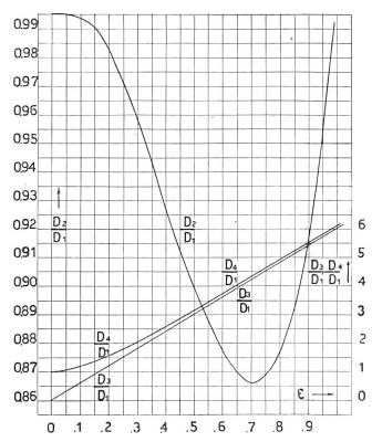
Fig. 2. Distorsioni composite «specifiche» armoniche (D<sub>2</sub>/D<sub>1</sub>), non armoniche  $(D_3/D_1)$  e globali  $(D_4/D_1)$  per un canale telefonico a caratteristica di lavoro cubica-simmetrica nel caso di eccitazione mediante uno spettro di due onde di rapporto  $\varepsilon$
