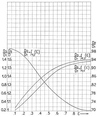
Fig. 3. Distorsioni composite «specifiche» armoniche (D<sub>2</sub>/D<sub>1</sub>), non armoniche  $(\bar{\mathrm{D}}_{3}/\mathrm{D}_{1})$  e globali  $(\mathrm{D}_{4}/\mathrm{D}_{1})$  per un canale telefonico a caratteristica di lavoro quadratica quando è soddisfatta la condizione che la potenza d'uscita nel passaggio dall'eccitazione con onda sinoidale armonica semplice all'eccitazione mediante uno spettro di due onde di rapporto  $\varepsilon$ , rimanga invariata
