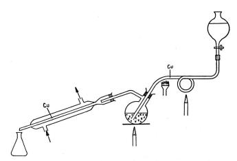
Fig. 1. Apparatur für die Wasserdampfdestillation
