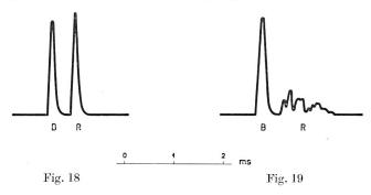
flektierenden Schicht. Typisch für den langsamen Schwund waren stets die Oszillogramme von der Art der Fig. 18 und für den schnellen Schwund die Oszillogramme gemäss Fig. 19, wobei B und R die am Beobachtungsort Bern eintreffenden Boden- und Raumwellenpulse unterscheiden. Im vorliegenden Zusammenhang sei auch an die früheren, aufchlussreichen Untersuchungen von Appleton, Ratcliffe, Zenneck und anderen erinnert<sup>5</sup>).
