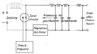
Fig. 2. Impuls-Modulationsschaltung
