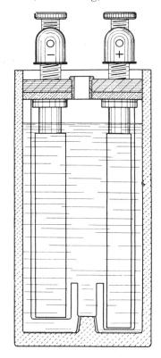
Fig.~2. Tragbarer Akkumulator Typ "Akkomet II"  $8\times8\times18$ cm, Säure 1,150 . . . 1,210 spez. Gew. im Normalzustand
