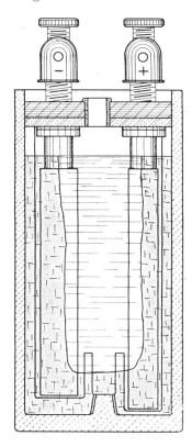
Fig. 3. Tragbarer Akkumulator Typ "Akkomet II", im entladenen Zustand bei —  $34^{\circ}$  C eingefroren: Eis am Boden und den Wänden entlang, im Innern flüssige Säure vom spez. Gew. 1,231
