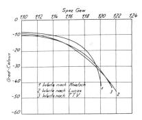
Fig. 1. Gefriertemperatur der Schwefelsäure in Abhängigkeit vom spezifischen Gewicht. Betriebsmässige Schwankungen des spezifischen Gewichts 1,165 . . . 1,219.
