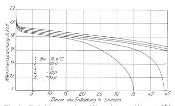
Fig. 4. Entladekurven eines Akkumulators "Akkomet II" bei verschiedenen Temperaturen. Entladung mit 0,5 A.
