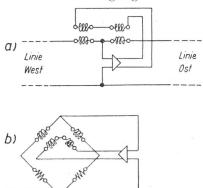
Fig. 1. Prinzip des Zweiweg-Ein-Element-Verstärkers. Fig. 1a zeigt die Einschaltung des Differentialübertragers in die Leitung. In Fig. 1b ist dieselbe Schaltung als Wheatstonesche Brücke umgezeichnet, wobei die Impedanzen der «Linie Ost» und «Linie West» durch Widerstände dargestellt sind
