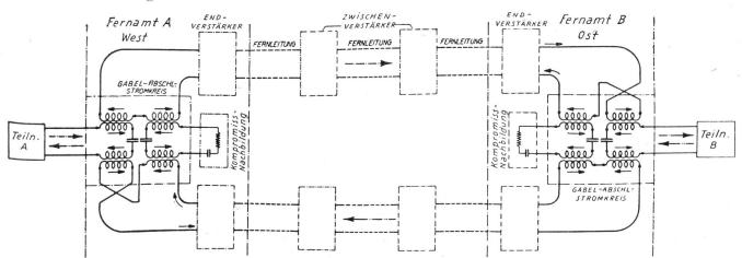
Fig. 6. Prinzipschaltbild der Vierdraht-Leitung
