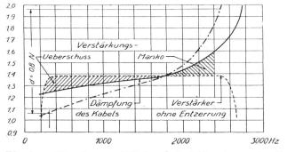
Fig. 4a. Dämpfungsverhältnisse bei nicht entzerrender Verstärkung
