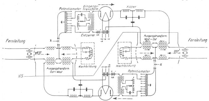
Fig. 2. Schaltung des Zweidraht-Verstärkers (Zweiweg-Zwei-Element-Verstärker)
