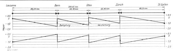
Fig. 5. Pegeldiagramm einer Zweidraht-Leitung mit 3 Fix-Verstärkern
