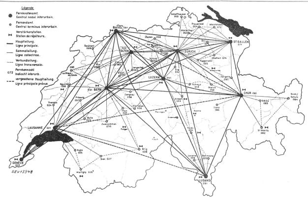
Fig. 8. Automatisches Fernnetz, projektierter Endausbau
