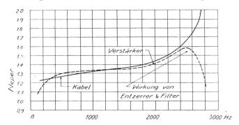
Fig. 4b. Anpassung des Verstärkungsverlaufes an die Dämpfung der Pupinleitung
