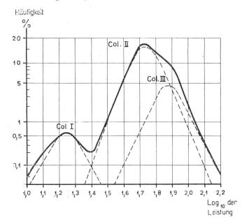
Fig. 15. Verteilung der Häufigkeit der Empfänger in Funktion ihrer Leistung und Verteilung der verschiedenen Kollektive. (Die Klassenbreite entspricht einem Leistungsverhältnis von 1,1195, dessen  $\log_{10}$  gleich 0,05 ist.)
