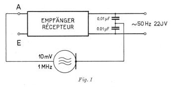
3. Aux récepteurs hétérodynes, la tension perturbatrice mesurée entre les bornes d'antenne et de terre ne doit pas dépasser les valeurs effectives suivantes: auf den Erdanschluss des Apparates, folgende Effektivwerte nicht überschreiten:
