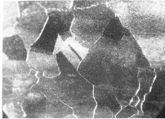
Fig. 5. Gefüge in der Längsschnittfläche des Kabelmantels
