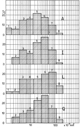
Fig. 7. Häufigkeitsverteilung der Korngrössen A = Aussenfläche; I = Innenfläche; L = Längsschnittfläche; Q = Querschnittfläche. (Die Zahlen über den Säulen: Grössenklasse)
