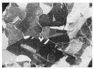
Fig. 3. Gefüge der Innenfläche des Bleimantels
