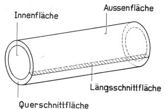
Fig. 1. Die untersuchten Flächen des Bleimantels
