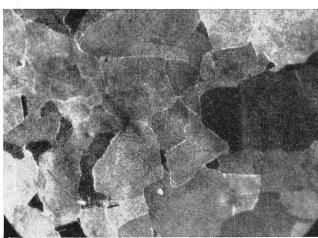
Fig. 2. Gefüge der Aussenfläche des Bleimantels
