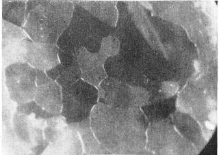
a  $\label{eq:Fig.6.} \textit{Fig. 6.} \quad \textit{Gefüge in der Querschnittfläche des Kabelmantels}$
