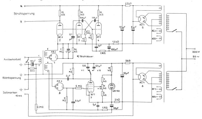
Fig. 7. Schema des Steuergerätes
