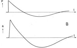
Fig. 12. Berechnete Amplituden a des Mittelohres, hervorgerufen durch einen Knall (Fall A) und eine Explosion (Fall B)
