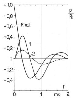
Fig. 13. Dämpfung eines Knalles durch einen Resonator (Ohrschutz)
