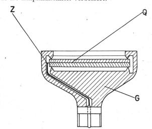
Schematischer Schnitt durch das Quarzmikrophon Quarzelement (Biegungsschwinger), Zuleitung, Gehäuse
