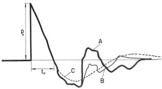
Fig. 9. Analytische Approximation des Mündungsknall-Oszillogrammes der 2-cm-Flab-Kanone
