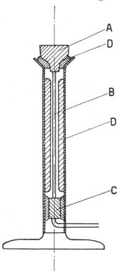
Fig. 4. Schematischer Schnitt des zusammengebauten Mikrophons
