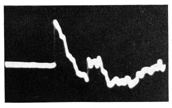
Fig. 8. Oszillogramm des Mündungsknalles einer 2-cm-Flab-Kanone
