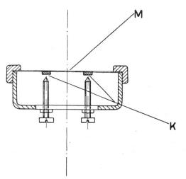
Schematischer Schnitt durch den druckgesteuerten Kontakt Membran, Kontakte
