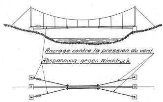
Fig. 5. Windabspannungen
