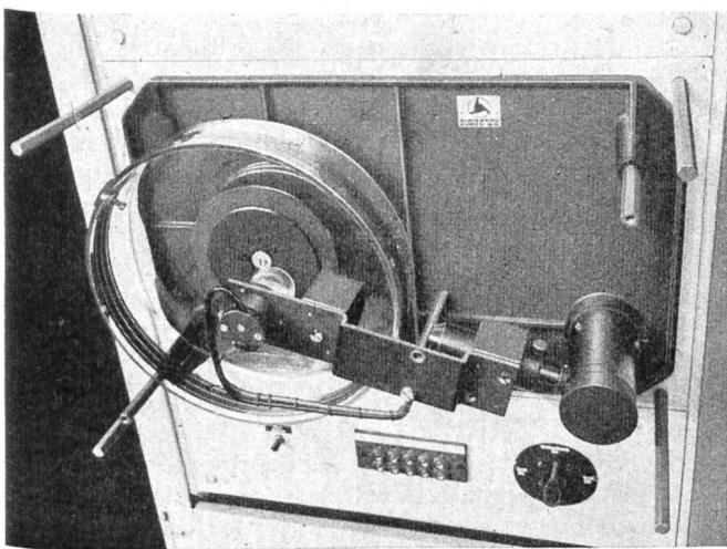
Fig. 3. Die Lichtton-Ansageeinrichtung ohne Deckel
