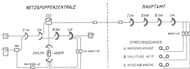
Fig. 2. Anschaltung mehrerer Lichtton-Ansageeinrichtungen
