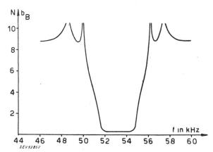
Abb. 22. Betriebsdämpfung des Quarzfilters der Fig. 21
