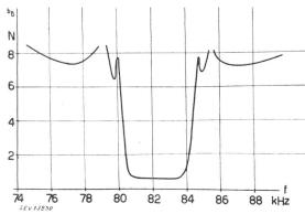
Abb. 20. Betriebsdämpfung des Filters Fig. 19
