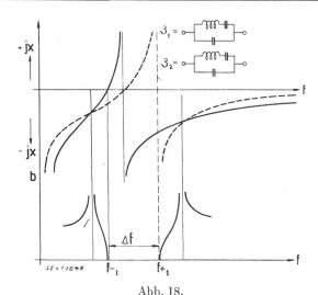
Brückenfilter mit zwei paarweise gleichen Schwingkristallen
