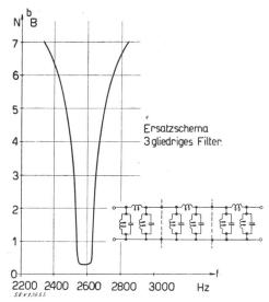
Abb. 25. Ersatzschema und Betriebsdämpfung eines dreigliedrigen elektromagnetischen Filters gemäss Fig. 23
