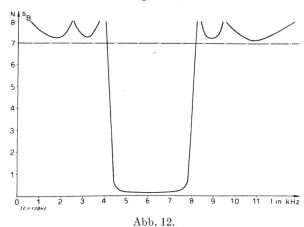
Gemessene Betriebsdämpfung des Abzweigfilters in Fig. 11
