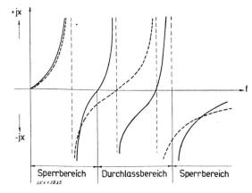
Abb. 5. Durchlass und Sperrbereich bei einem Brückenfilter
