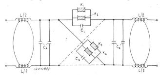
Abb. 21. Schaltung eines BBC-Ammoniumphosphatfilters
