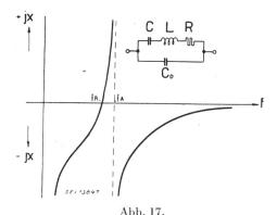
Ersatzschema des Schwingkristalls und zugehöriger Scheinwiderstandsverlauf, bei Vernachlässigung der Verluste (R=0)
