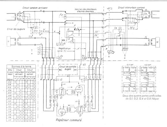
Fig. 14. Principe de l'établissement de la communication à travers des répéteurs commutés dans un central tandem
