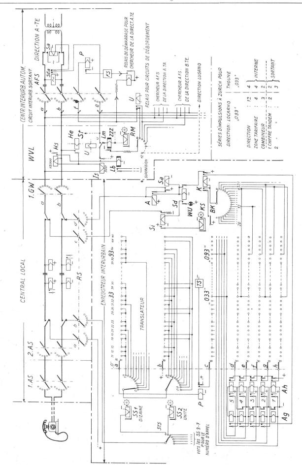
Fig. 12. Traduction du chiffre indicatif interurbain (translation dans l'enregistreur interurbain)
