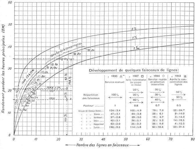
Fig. 16. Développement de quelques faisceaux de lignes et rendement des lignes en faisceaux complets
