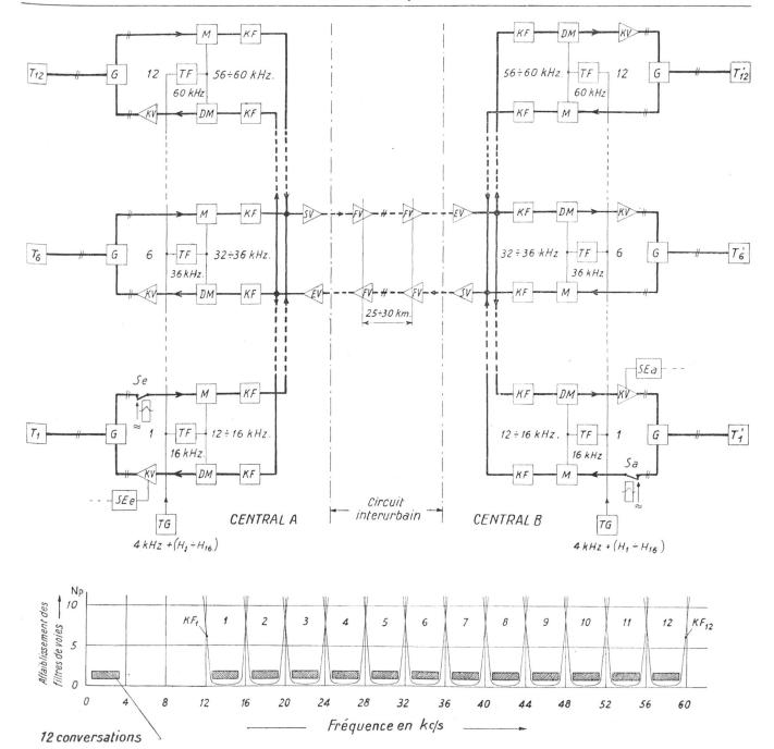
Fig. 17. Schéma d'une installation à courants porteurs
