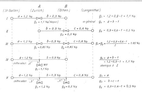
Fig. 13. Réglage du gain sur les communications amplifiées à demeure et sur les communications tandems
