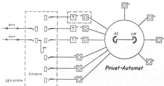
Fig. 4. Haustelephon-Anlage mit Vermittlerschrank für den Amtsverkehr und privatem Automat für den Hausverkehr (Zweischielefanlage). Zwei Apparate oder eine kombinierte Station für jeden amtsberechtigten Teilnehmer
