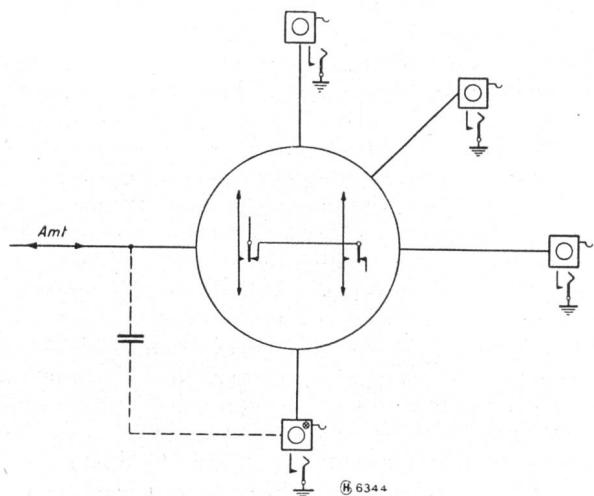
Fig. 3. Telephonanlage für eine Amtsleitung und zehn Zweigstationen (Relaisautomat I/10)
