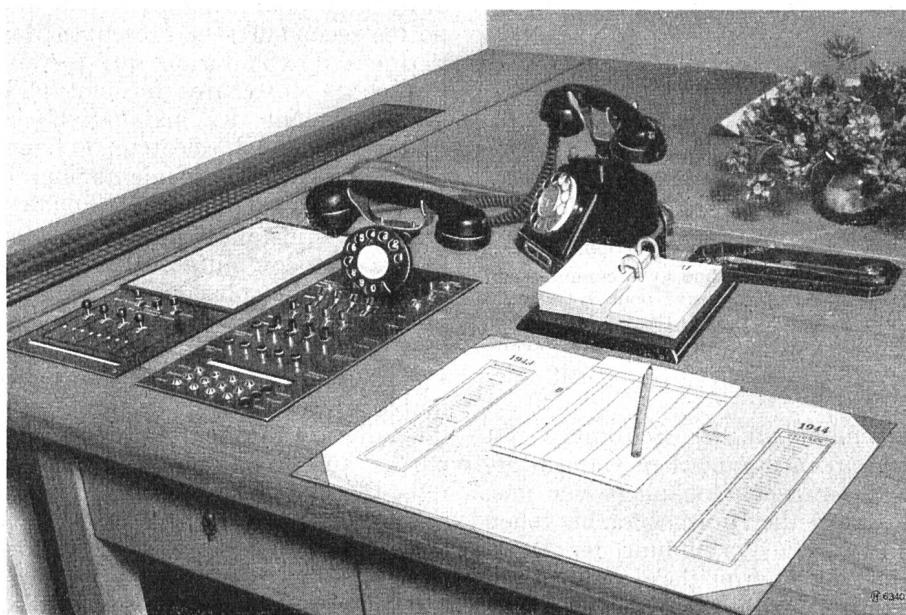
Fig. 6. Vermittlerplatte für maximal fünf und ausgebaut für vier Amtsleitungen. Links daneben eine Bedienungsplatte für manuelles Betätigen der Personensuchanlage. Diese kann vom Automaten aus und durch die Telephonistin in Betrieb gesetzt werden. Der Tischtelephonapparat bietet einen zusätzlichen Anschluss an den Hauptautomaten.
