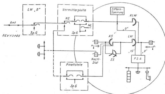
Fig. 5. Telephonanlage mit Vermittlerplatte. Die drei verschiedenen Möglichkeiten für Nachschaltungen sind angedeutet
