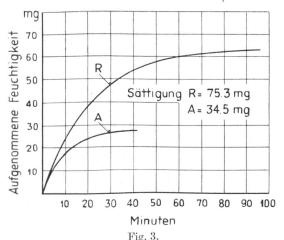
Wasseraufnahme von Kabelpapier bei 47% relativer Luftfeuchtigkeit. R = Rohpapier 0,9469 g,
