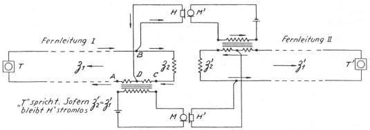
Fig. 2d. Kombination zweier Telephonstromkreise nach Fig. 2c
