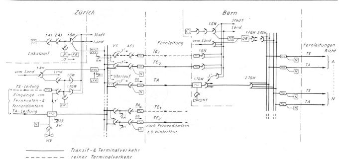
Fig. 10. Prinzipielle Leitungsschaltungen in den Tandemämtern Bern und Zürich
