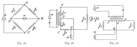
Fig. 2a...e. Anwendung der Brückenschaltung im Zweidrahtverstärker
