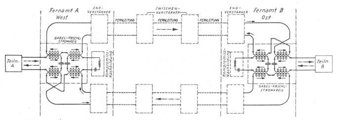
Fig. 5. Schaltung der Vierdrahtleitung
