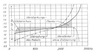
Fig. 4a. Dämpfungsverhältnisse bei nicht entzerrender Verstärkung
