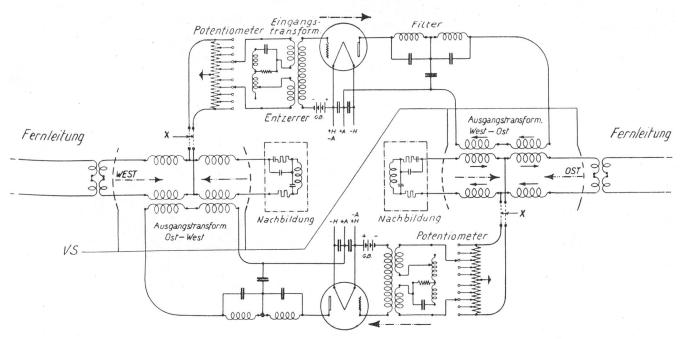
Fig. 3. Aufbau des Zweidrahtverstärkers
