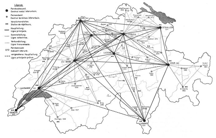
Fig. 9. Automatisches Fernnetz; projektierter Endausbau
