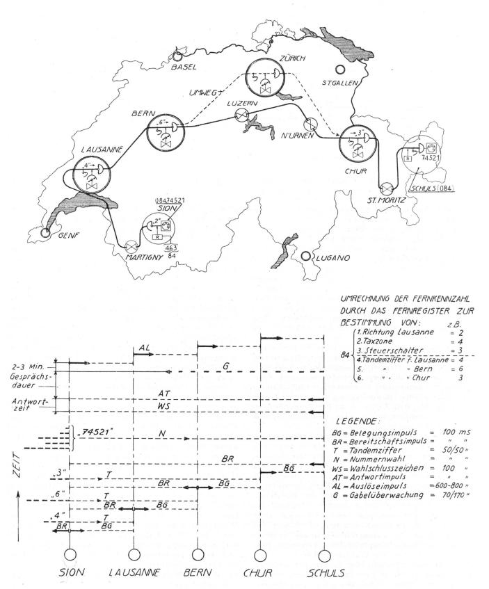
Fig. 11. Aufbau einer Verbindung Sion-Schuls mit entsprechendem Impulsdiagramm
