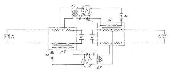
Fig. 2e. Grundprinzip des Zweidraht-Verstärkers
