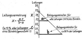
Fig. 2. Berechnung der Leitungsvermehrung.
