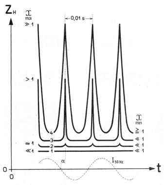
Fig. 7. Typische Pulsationsmuster eines Heizelementes.
