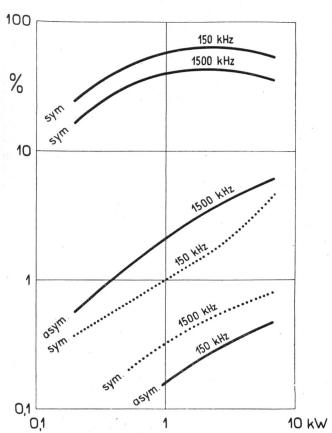
Fig. 11. Störmodulationsgrad der Betriebsimpedanz eines mittleren Kochherdes.
