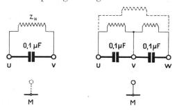
Fig. 12. Grobstörschutz durch Kondensatorbeschaltung.
