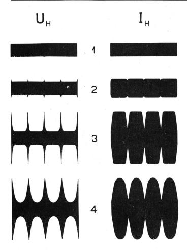
Fig. 8. Grundformen der Sekundärmodulation im Heizkreis.
