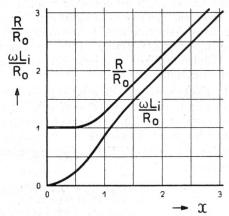
Fig. 5. Skineffekt am homogenen Runddraht.
