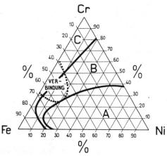
Fig. 1. Phasenverteilung im Dreistoffsystem Chrom-Nickel-Eisen bei Raumtemperatur.
