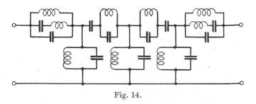
complexité des problèmes qui se posent pour les réaliser en pratique. A titre d'exemple, nous donnons le schéma d'un filtre passe bande tel qu'il est utilisé dans un système à courants porteurs; les diverses cellules, comme on le voit, sont assez différentes des cellules de base (figure 14).
