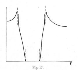
$Z_A$  et  $Z_B$ , à condition que la fréquence d'anti-résonance d'un bras coïncide avec la fréquence de résonance de l'autre, c'est-à-dire que le point  $f_A$  d'un bras corresponde au point  $f_R$  de l'autre. Ceci est illustré à la figure 17 où l'on a indiqué également la courbe d'affaiblissement qui en résulte. (à suivre)
