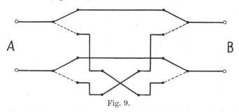
En A nous aurons l'entrée du courant à moduler et en B la sortie du courant modulé par le porteur correspondant à la coupure et l'inversion de phase (ce qui revient dans l'exemple mécanique à croiser périodiquement les fils) au moyen du commutateur.
