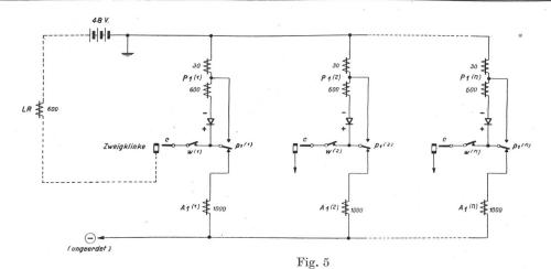
Speiserelais Ua, bzw. Ub über den Zweig kurz ansprechen; das Schlusszeichenrelais W fällt neuerdings ab und gibt den c-Draht des Zweiges wieder frei. Hierauf spricht P1 oder P2 wieder an. Durch das inzwischen ebenfalls abgefallene Relais D1 oder D2 würde ein neuer Ruf nach der internen Station eingeleitet, was jedoch nicht erwünscht ist.
