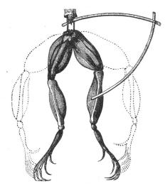
Versuch mit dem aus zwei verschiedenen Metallen bestehenden C-förmigen Bogen.
