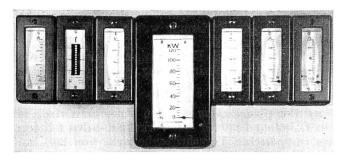
Abb. 1. Messblock einer Generatorschalttafel, bestehend aus 6 Spannungs-, Strom- und Frequenzanzeigern in Flachprofilgehäuse  $155\times70\,$  mm und 1 Wattmeter  $235\times110\,$  mm.
