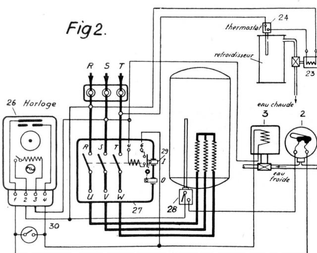
tisches Ventil 23, das durch einen Thermostaten 24 gesteuert wird, anzubringen, um die Leitung erst dann zu öffnen, wenn die Wassertemperatur im Kühler auf 50° C gestiegen ist. Erst wenn der Warmwasserbehälter 22 gefüllt ist, tritt das überschüssige Kühlwasser bei 26 aus und läuft in den Abwasserkanal.
