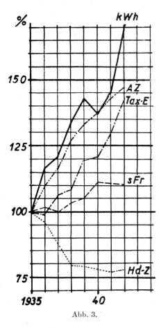
Abb. 3. Zunahme des Elektrizitätsverbrauchs (kWh), der entsprechenden Kosten (sFr.), der Anzahl zur Verrechnung gelangter Taxeinheiten zu 0,1 sFr. (Tax-E), des Anlagewertes der automatischen Zentralen (AZ) und Abnahme des Anlagewertes der handbedienten Zentralen (HdZ) in % der Werte 1935.
