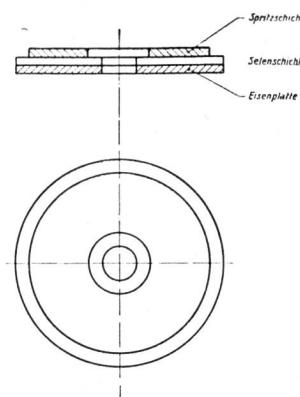
Fig. 3. Schnitt durch eine Selengleichrichter-Scheibe.
