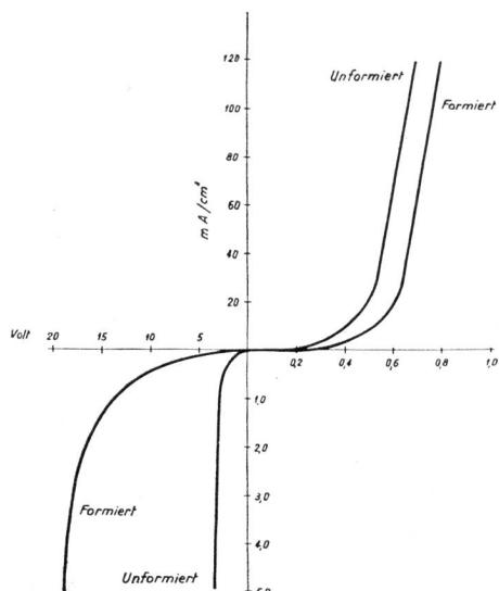
Fig. 8. Volt-Ampère-Charakteristik von Selengleichrichtern vor und nach der Formierung.
