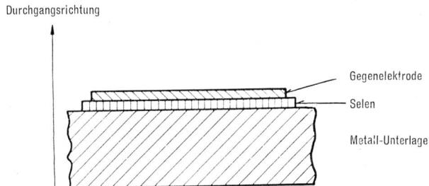
Fig. 2. Schematische Schnittzeichnung durch eine Selen-Gleichrichterzelle.
