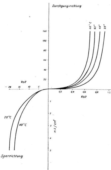
Fig. 6. Durchgangs- und Sperrichtungs-Kurven von Selengleichrichtern bei verschiedenen Temperaturen.
