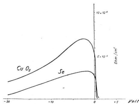
Fig. 4. Widerstandsänderung neuer Selen- und Kupferoxydul-Gleichrichter in Funktion der angelegten Spannung. Modification de la résistance des nouveaux redresseurs au sélénium et à oxyde de cuivre en fonction de la tension appliquée.
