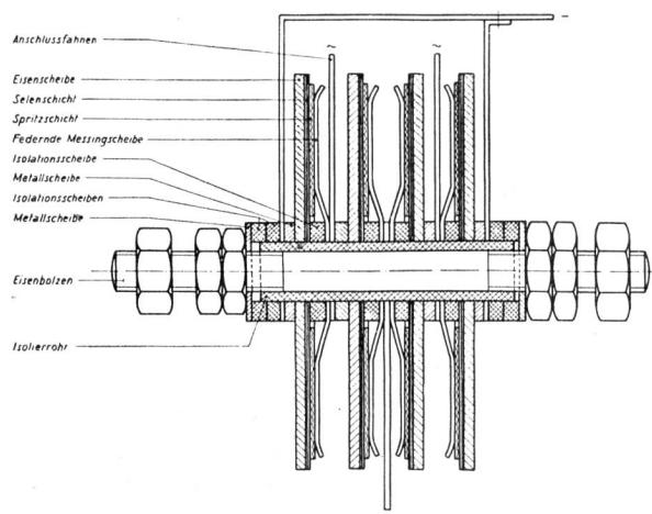
Fig. 9. Aufbau eines Selengleichrichter-Elementes in Graetzschaltung für Einphasen-Wechselstrom.
