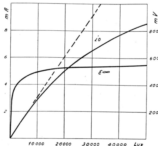
Fig. 12. Leerlaufspannung  $\epsilon^\infty$  und Kurzschlussstrom  $i_0$  eines Selenphotoelementes. (Lichtempfindliche Oberfläche =  $10 \text{ cm}^2$ ).
