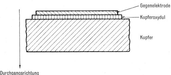
Fig. 1. Schematische Schnittzeichnung durch eine Kupferoxydul-Gleichrichterzelle.
