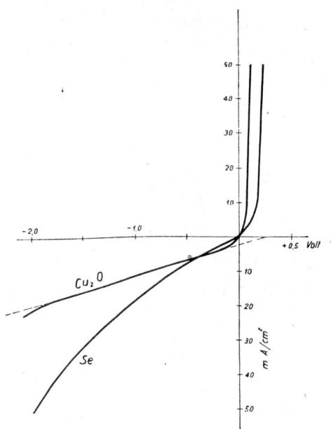
Fig. 7. Volt-Ampère-Charakteristik von Selen- und Kupferoxydulgleichrichtern bei kleinen Spannungen.
