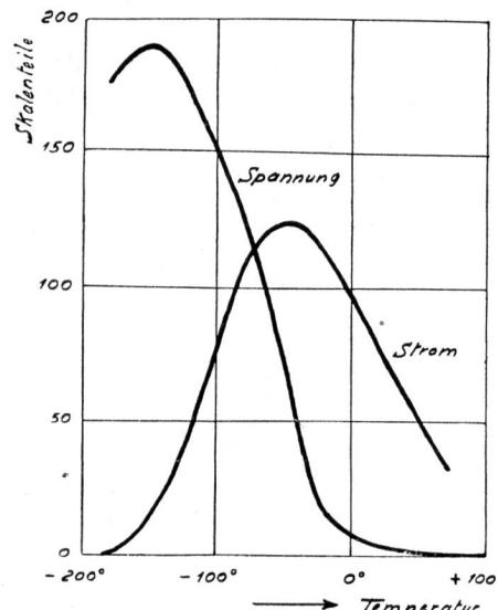
Fig. 14. Temperatur-Abhängigkeit des Photoeffektes einer Kupferoxydul-Zelle.
