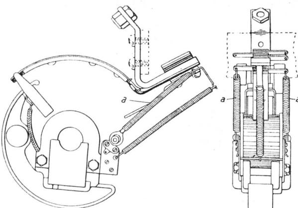
Fig. 10. Zeitalarmeinrichtung älterer Konstruktion. — Dispositif d'alarme de durée d'ancienne construction.
