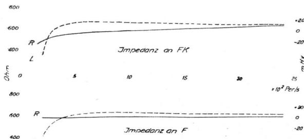
Fig. 4a. Konferenzschaltung 40. Impedanz der *F*-Gabel. Dispositif pour communications collectives 40. Impédance du termineur *F*.
