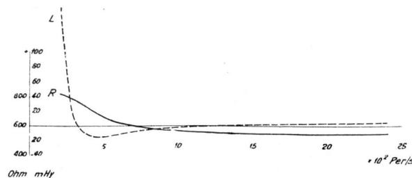
Fig. 4b. Konferenzschaltung 40. Impedanz der *T*-Gabel. Dispositif pour communications collectives 40. Impédance du termineur *T*.
