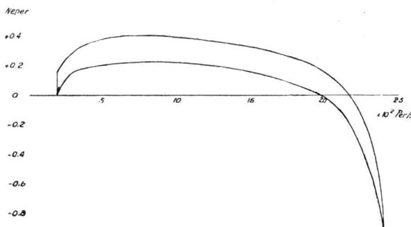
Fig. 3. Konferenzschaltung 40. Restdämpfungen in der *H*-Gabel. Dispositif pour communications collectives 40. Équivalent dans le termineur *H*.
