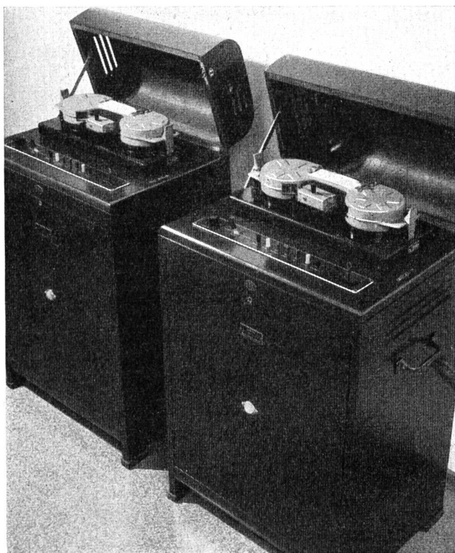
Abb. 1. Textophon-Maschinengruppe in der Telephonzentrale.
