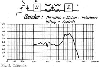
Fig. 2. Sender = Emetteur. Teilnehmerleitung = Ligne d'abonné.
