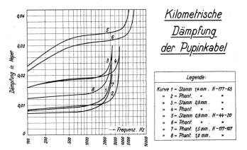
Légende: Kilometrische Dämpfung der Pupinkabel = Amortissement kilométrique des câbles Pupin. Stamm = Circuit de base. Phant. = Circuit fantôme.
