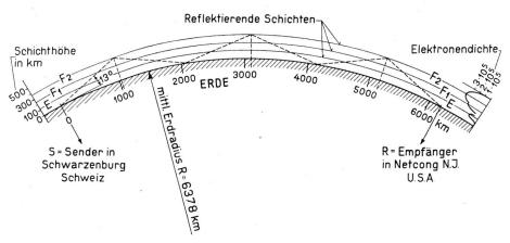
Fig. 1. Schematischer Aufbau der Ionosphäre für einen Sommertag.
