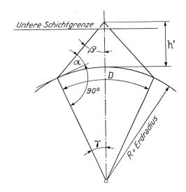
Fig. 6. Geometrische Beziehungen des Abstrahlwinkels a und Einfallwinkels  $\beta$ .
