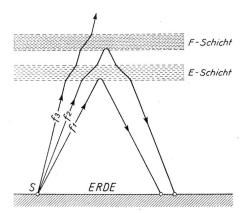
Fig. 3. Reflexion von kurzen Wellen.
