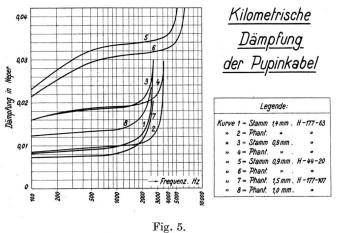
Aus Bild 5 ersieht man: Durch starke Spulenbelastung erhält man kleine Dämpfung bei relativ schmalem Frequenzband. Bei leichter Spulenbelastung ist die Dämpfung gross, dafür wird das Frequenzband breit. Je nach der Pupinisierung liegen die Grenzfrequenzen unserer normalen Kabel bei 2850, 3750, 5900 oder 7000 Hz. Die Fortpflanzungsgeschwindigkeit für 800 Hz bei Stammleitungen mit Pupinisierung H—177 errechnet sich in Annäherung aus der Formel
