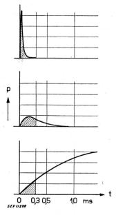
Abb. 29: Schalldruckverlauf von drei Einzelknacken der gleichen Lautstärke 165 Phon. Nur die ersten 0,3 ms (schraffierte Flächen) sind für die empfundene Lautstärke massgebend, der spätere Verlauf ist belanglos (nach Steudel).
