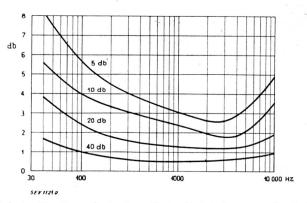
Abb. 12: Gerade noch hörbare Intensitätsänderungen in db in Funktion der Frequenz für verschiedene Intensitäten (0 db =  $10^{-16}$  W/cm<sup>2</sup>) (nach Fletcher).
