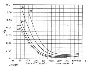
Abb. 13: Gerade noch hörbare Frequenzänderungen in Funktion der Frequenz für verschiedene Intensitäten (0 db = 10-16 W/cm²) (nach Shower und Biddulph).
