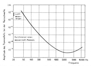
Mechanische Abb. 11: Die Schwingungsamplitude des Trommelfells bei der Reizschwelle (nach Wilska).
