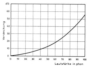
Abb. 25: Verdeckungseffekt eines Geräusches mit gleichmässiger Energieverteilung (Rauschen) (nach Fletcher).
