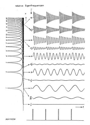
Abb. 26: Die Wirkung periodischer Impulse (obertonreiches Spektrum) auf die Resonanzkurven des Innenohrs. Durch die Ueberlappung der Kurven erscheint bei den höhern Obertönen die Frequenz des Grundtones wieder. Dieser Effekt ist das sog. Residuum (nach Schouten).
