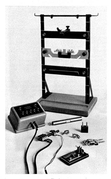
Fig. 2. Einige Zusatzteile: Ständer, Tastenkästchen, Klammern usw. Quelques accessoires: support, commutateur, pinces, etc.
