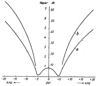
Abb. 5. Selektionskurven des Vorsatzgerätes bei 241 kHz.
