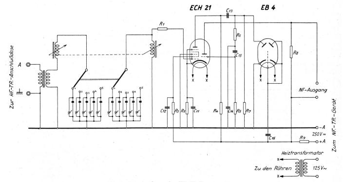
Abb. 1. Prinzipschema des HF-TR-Vorsatzgerätes.
