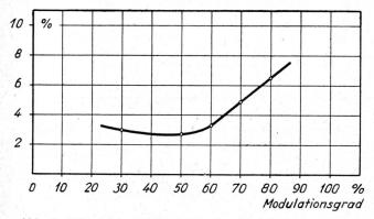
Abb. 3. Klirrfaktor in Funktion des Modulationsgrades.
