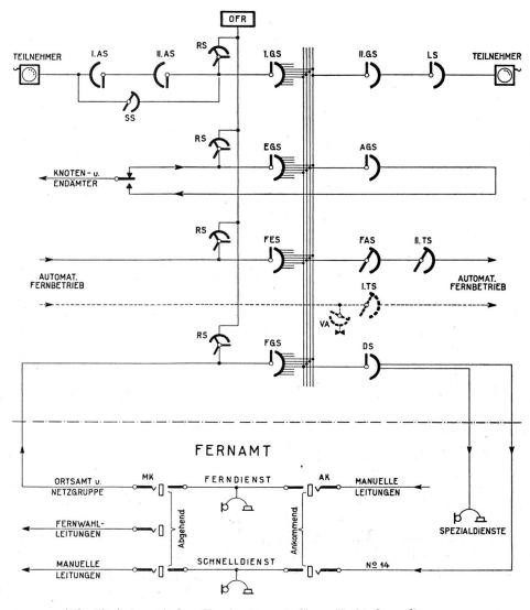
Abb. 16. Automatisches Fernknotenamt Chur, Verbindungsdiagramm.
