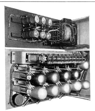
Abb. 2. Signalplatte, Rückseite; oben Stromlieferungsanlage.
