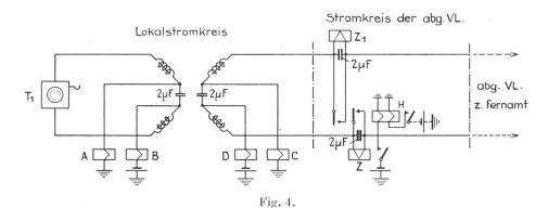
In einer Nebenstelle war im b-Draht der Amtslinie ein Ueberwachungsrelais eingeschaltet (s. Fig. 5). Der vorhin genannte Bahngleichrichter erzeugte auf diesem Amtsanschluss Geräuschspannungen bis zu 15 mV. Durch Verlegung des Relais in den Symmetriepunkt der Uebertragerspule (s. Fig. 6) und durch Paarung der Relais A/B und C/D wurde sozusagen restlos Abhilfe geschaffen. Die Unsymmetriewerte
