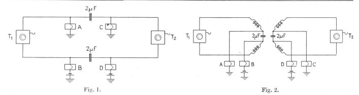
wo die Teilnehmerleitungen im Einflussbereich von Hochspannungsanlagen oder Bahngleichrichtern liegen, wirkt sich die kleinste Unsymmetrie der Speiserelais A/B und C/D sofort als Geräuschursache aus. Das Eindringen von Geräuschen auf die Sprechverbindung kann nur durch impedanzmässig genaue Paarung der Relais oder durch Einbau einer symmetrischen Uebertragerspule verhindert werden (s. Fig. 2).
