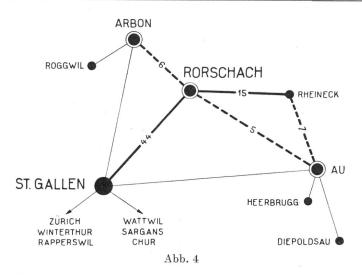
Rorschach ist Knotenamt für das Endamt Rheineck und ist ausser mit dem Hauptamt St. Gallen noch mit weitern Zentralen gemäss Abb. 4 verbunden. Das Knotenamt Rorschach enthält im ersten Ausbau 1700 Teilnehmeranschlüsse, die Verbindungsleitungen nach Abb. 4 und die Einrichtungen für Hochfrequenz-Telephonrundspruch nach dem von der Verwaltung entwickelten System. Schliesslich befindet sich im Keller noch die Stromlieferungsanlage.
