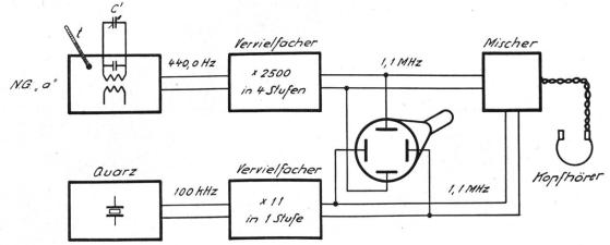
Fig. 3. Eichung des Generators. — Calibrage du générateur.
