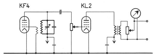
Fig. 1. Prinzipschema des Generators. — Schéma de principe du générateur.
