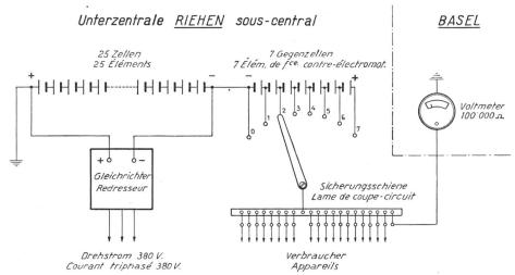
Fig. 3. Schaltung des Gleichrichters. — Montage du redresseur.
