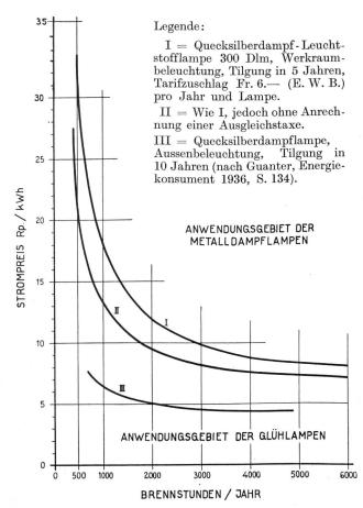
Abb. 6. Kurven gleicher Wirtschaftlichkeit für Glüh- und Metalldampflampen.
