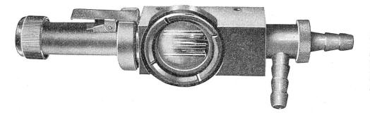
Abb. 2. Wassergekühlte Ueberhochdruck-Quecksilberdampflampe mit 15 000 Lumen nutzbarem Lichtstrom, für Anwendungen im Flugwesen, in der Photographie, für kleine Scheinwerfer. Energiebedarf 560 W einschliesslich Vorschaltgerät.
