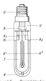
$K_1$  und  $K_2$  = Hauptelektroden.  $K_3$ = Hilfselektrode. Widerstand. R K' und K'' = Glasmänteln von umgebene Ueberbrückungsdrähte.
