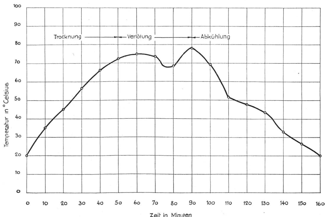
Fig. 7. Temperatures im Zentrum einer Spleissung beim Austrocknen und Verlöten.
