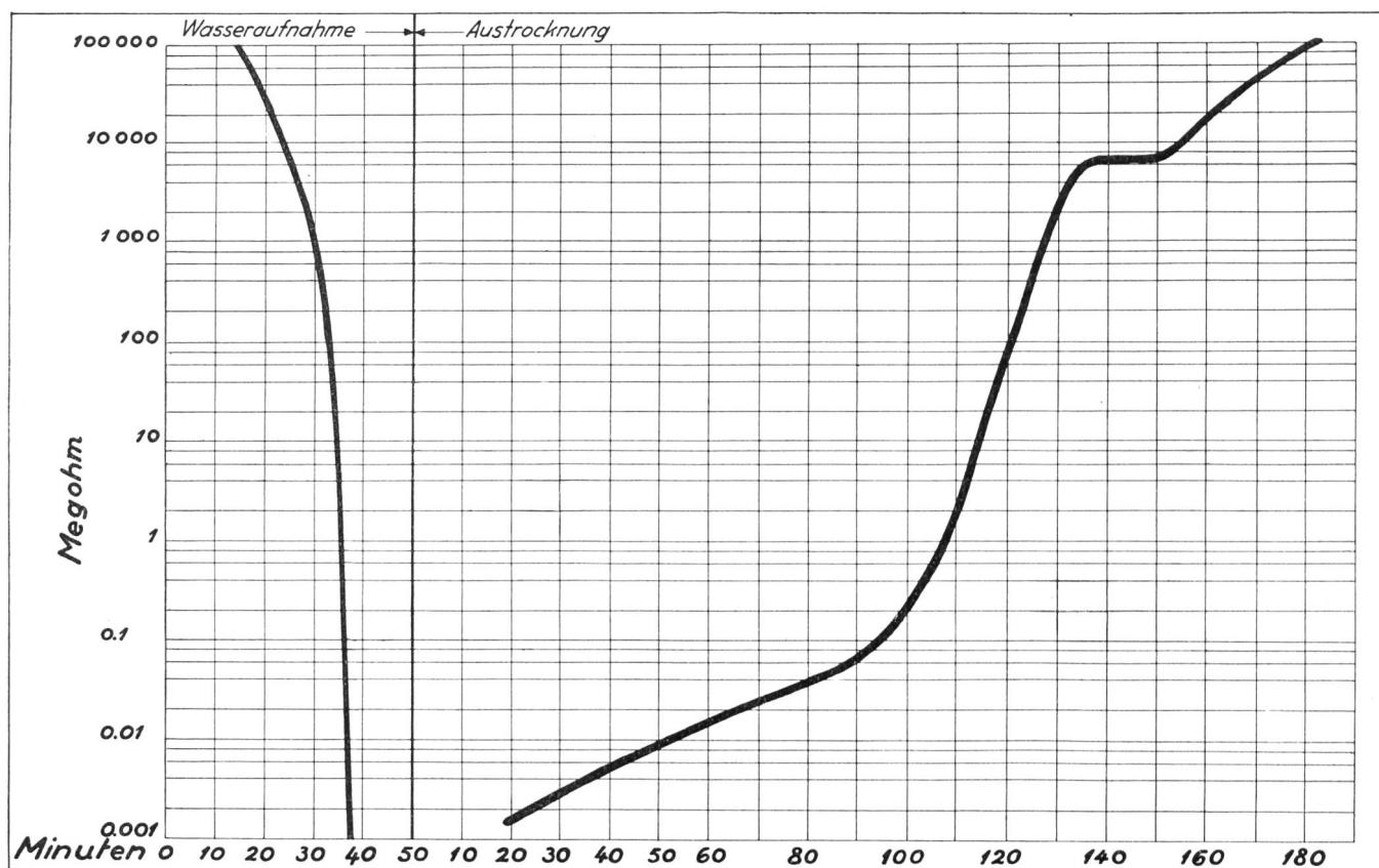
Fig. 8. Isolationszustände einer durch Wasser verdorbenen Spleissung. — Etat d'isolation d'une épissure détériorée par l'eau.
