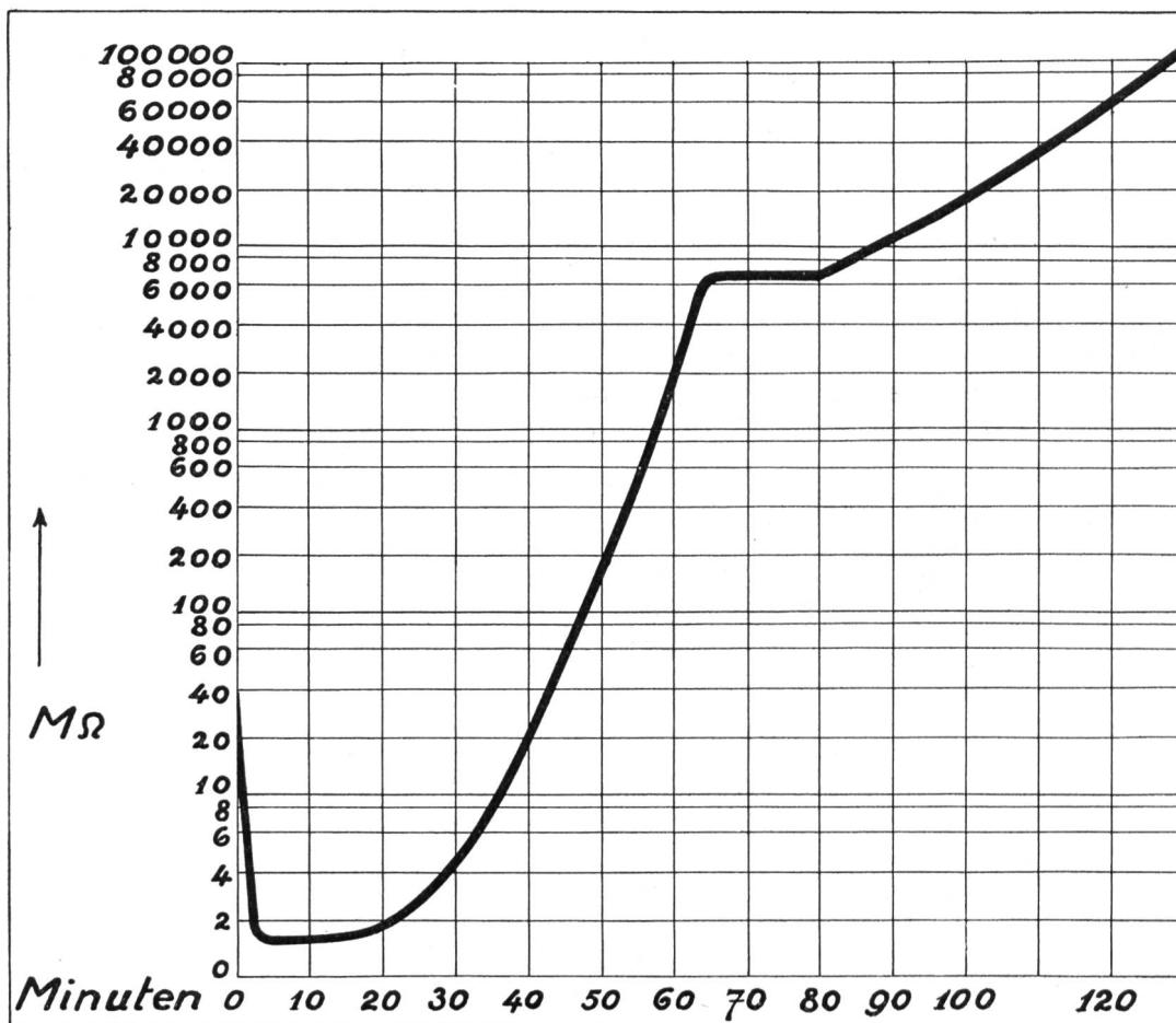
Fig. 4. Isolationszustand beim Austrocknen eines durch Luftfeuchtigkeit verdorbenen Kabels.
