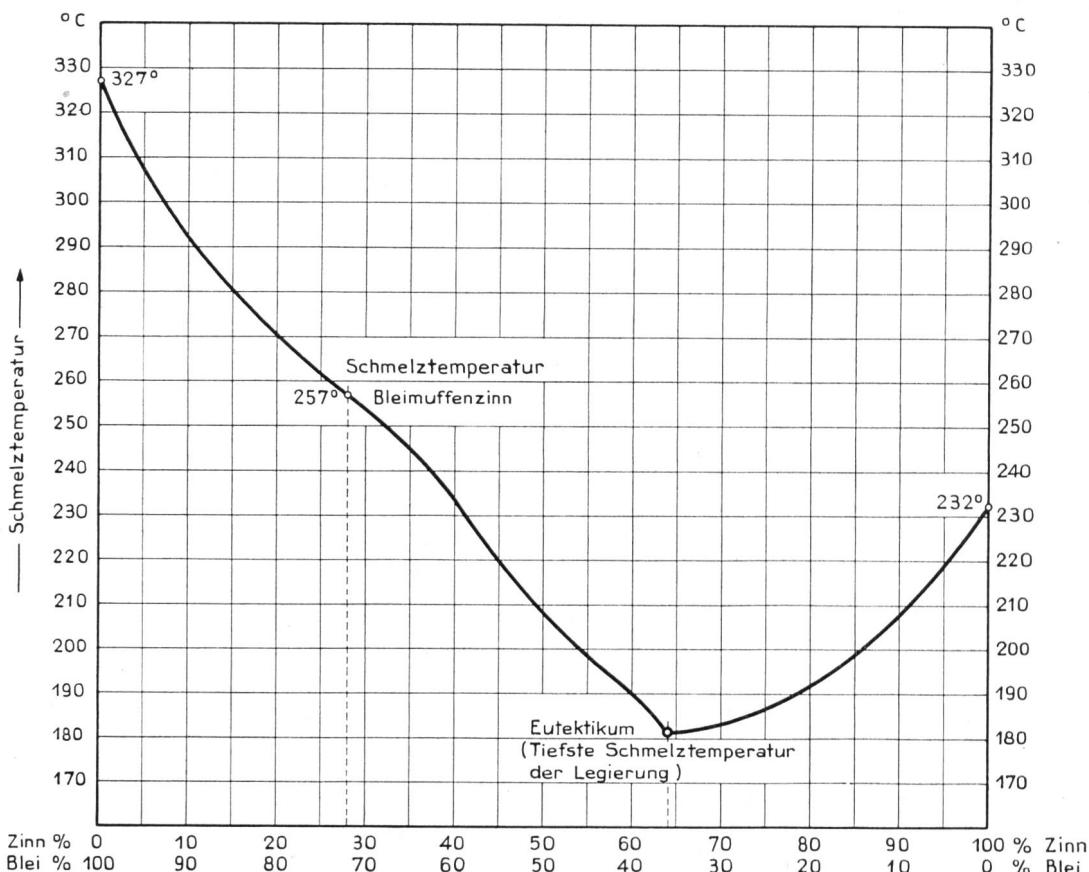
Fig. 6. Schmelztemperaturen der Blei-Zinn-Legierung. — Températures de fusion de l'alliage plomb-étain.
