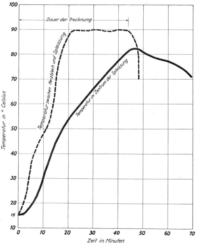
Fig. 5. Temperatur beim Austrocknen einer Spleissung.
