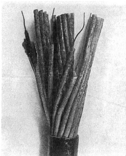
Fig. 2. Kabel mit baumwollisolierten und stanniolumwickelten Adern.
