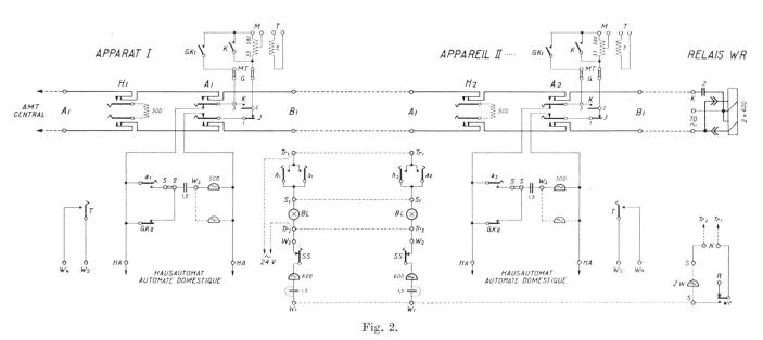
Bei kleineren Anlagen mit nur ein oder zwei Linienwählern kann das Wechselstromrelais weggelassen werden. In diesen Fällen werden die Amtswecker nach der letzten Station, direkt auf die Amtsleitung geschaltet.
