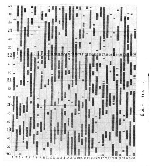
Fig. 3. Beobachtung der Schnurstromkreise (II. AS-I.GS). — Observation des circuits de cordons.
