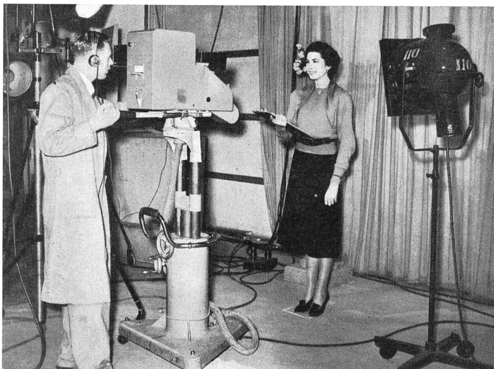
Abb. 2. Diese Abbildung zeigt die Fernseh-Kamera „Emitron“, die in Wirklichkeit ein elektrisches Auge darstellt. Vor ihr steht eine der beiden ständigen Fernseh-Ansagerinnen.
